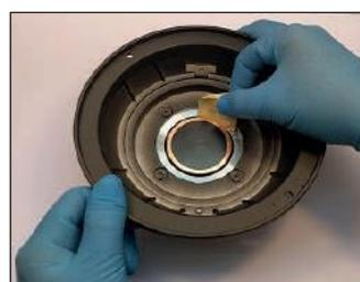
Pliez un morceau de ruban adhésif dans le sens de la longueur (70 mm x 25 mm x 1 mm), côté adhésif exposé, et insérez-le dans l'espace vide et faites-le tourner. Répétez cette opération jusqu'à ce que le ruban reste propre une fois retiré.
