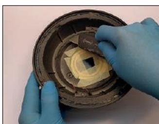
À l'aide de MEK et d'un cutter, nettoyez la surface inférieure du saladier en éliminant les restes de colle et du speeder.
