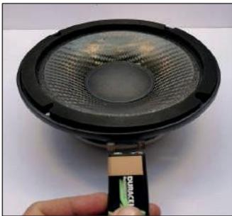
Vérifiez la polarité du haut-parleur à l'aide d'une batterie en connectant la borne positive de la batterie à la borne positive du haut-parleur. Faites de même avec les bornes négatives. La partie mobile doit se déplacer vers le haut.
