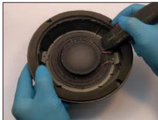
À l'aide d'un cutter, coupez les fils conducteurs de la bobine, le speeder et retirez le reste des composants de la partie mobile.
