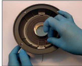
Insérez la calle en plastique dans le support de la bobine, placez la bobine à l'intérieur de l'entrefer et passez les fils conducteurs de la bobine à travers les trous des bornes et soudez.
