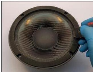
À l'aide d'un cutter, coupez la partie supérieure de la membrane.
