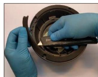
Retirez les joints et, à l'aide de MEK et d'un cutter, nettoyez la surface supérieure du saladier en éliminant les restes de colle et de suspension.
