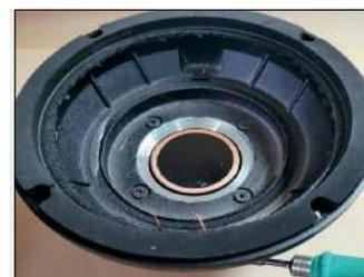
Dessouder les fils conducteurs de la bobine mobile de l'extérieur du saladier et vérifier le bon état de la connexion.
